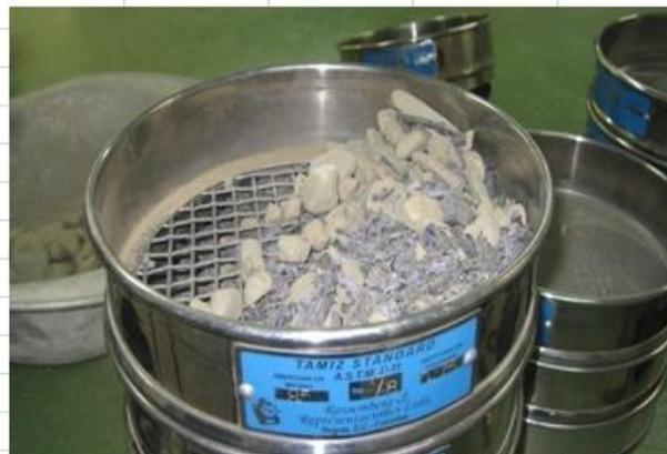
Foto. Granulometria Sub-base Granular (80%) + Material No Biodegradable (20%).
