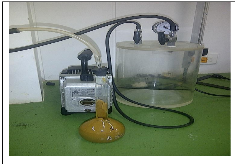
Figura 37: Desaireación de la lechada. Método vacío.
