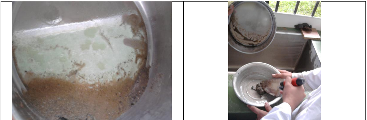
Figura 45: Material retenido al tamiz #200.
