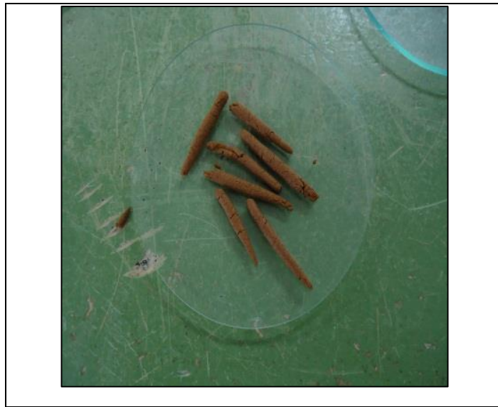
Figura 34: Rollos de suelos para límite plástico.
