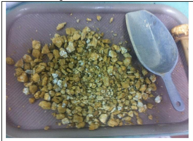
Figura 48: Muestra inalterada totalmente destruida.
