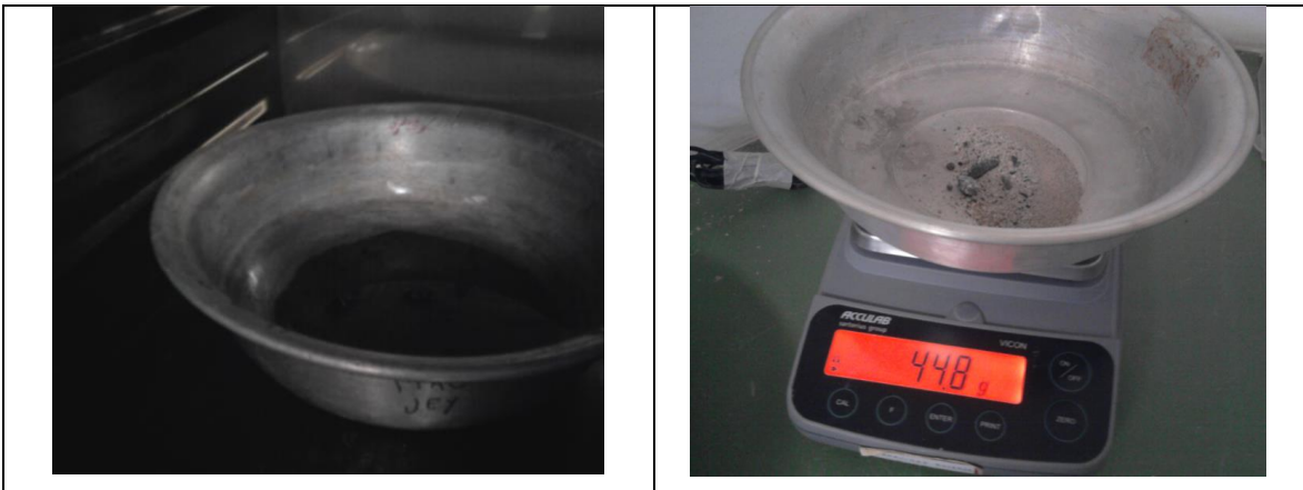
Figura 46: Material retenido tamiz # 200 horno.
