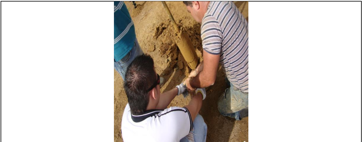
Figura 27: Extracción por barreno (muestra alterada).
