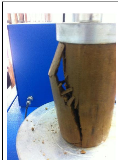
Figura 52: Falla muestra inalterada.
