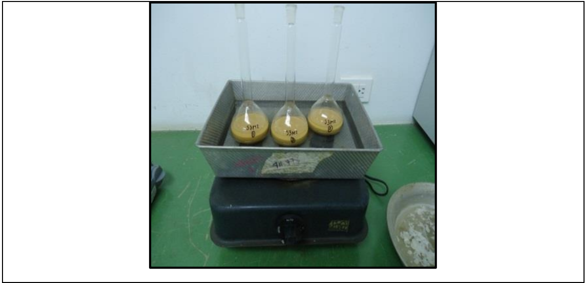
Figura 36: Desaireación de la lechada. Método calor.
