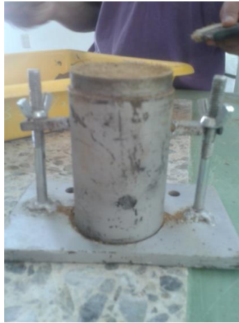
Figura 9 Armado de cilindros para el ensayo de compresión inconfiada mediante miniproctor
