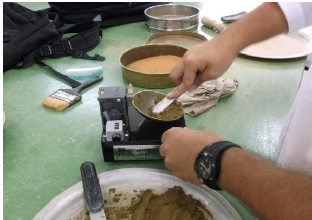
Figura 2 Procedimiento de laboratorio para la obtención del Límite Líquido
