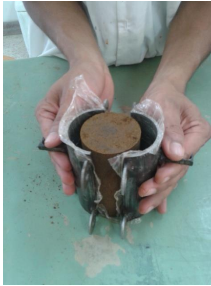
Figura 10 Recuperación de cilindros del miniproctor modificado
