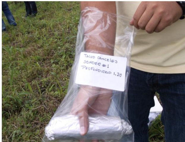
Figura 7 Preparación de muestras inalteradas para la obtención de resultados mediante pruebas de laboratorio
