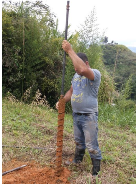
Figura 6 Toma de muestras inalteradas del talud cancelés
