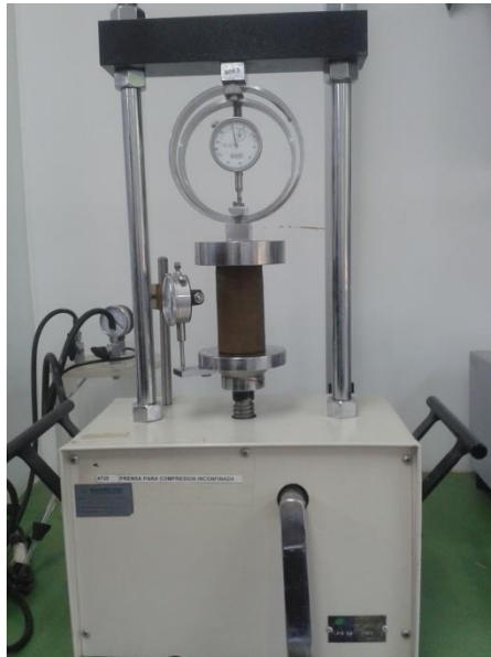
Figura 4 Equipos utilizado para ensayo de compresión inconfiada
