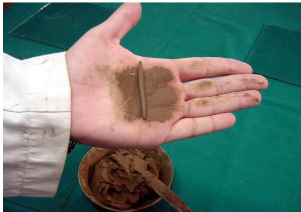
Figura 3 Procedimiento de laboratorio para la obtención del límite Plástico (Límites de Atterberg)
