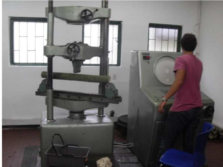
Figura 94. Prueba flexión de la guadua. Fuente: los autores
