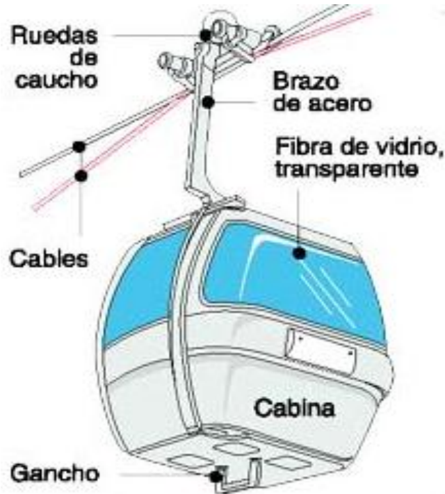
Grafica 10. Partes de una cabina de teleférico.
