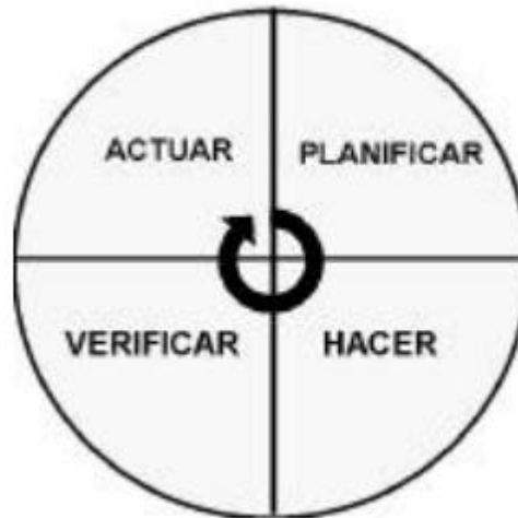
Fig.1. Ciclo de Deming por sus siglas en ingles PDAC (Plan, do, check, act). También conocido como espiral de mejora continúa 12 .
