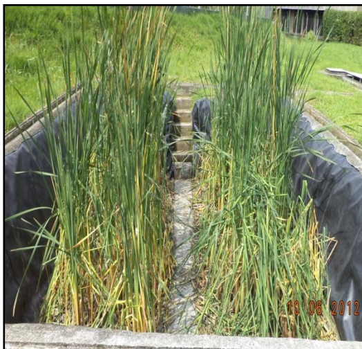
Foto 7 y 8 Humedal de flujo subsuperficial sembrado con typha. Fuente propia (Estudiantes) (AMAR/MIP)
