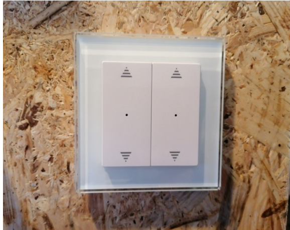
Slika 5.12. KNX tipkalo sastavljeno iz nekoliko komponenti
