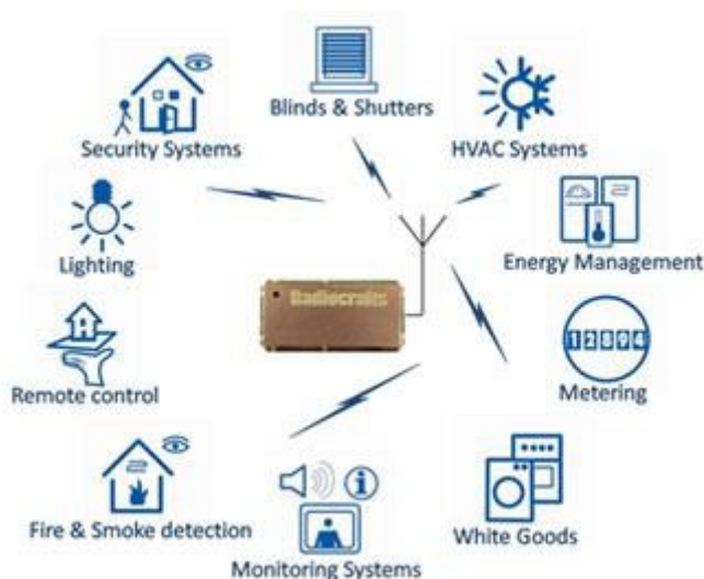
Slika 3.4. KNX sustav bežične komunikacije [5]
