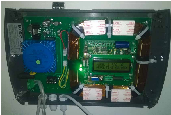
Kuva 3.11. Seinän kosteudenpoistolaite ja johtokykymittaus seinärakenteeseen asennetulla harja-anturiparilla (vasen yläkuva). Esimerkki kuivatettavasta rakenteesta (oikea yläkuva). Prosessiohjattu kosteudenpoistolaite, master-laite (EcoDry Zeta III) (vasen alakuva). Slave-laite (INPOINT) (oikea alakuva). (Kuvat: Esko Sistonen)
