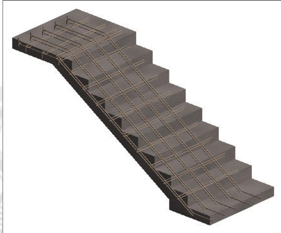
Figura 68 - Diseño: 3D de Escalera Principal realizado en Revit Structure
