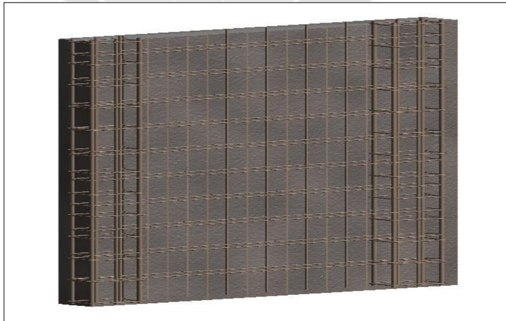
Figura 50 - Diseño: 3D de Placa diseñada realizada en Revit Structure
