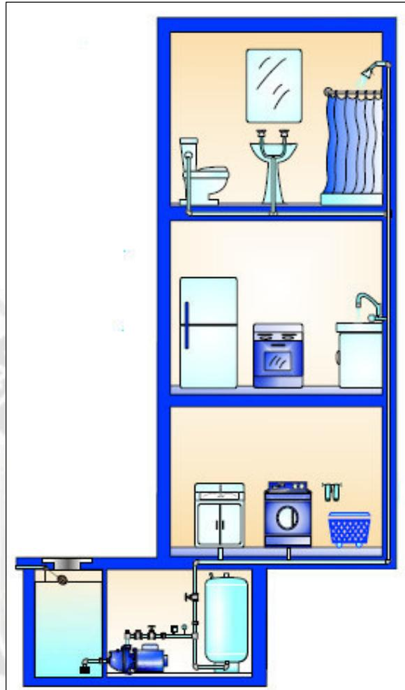
Figura 81 - Sistema Indirecto con Tanque Hidroneumático – Fuente: HIDROSTAL.
