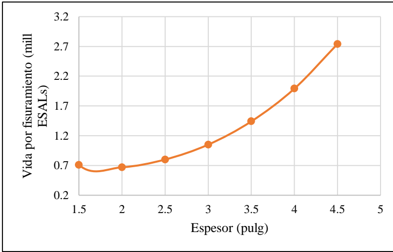
Gráfico N°8. 8. Variación de espesor de capa vs vida por fisuramiento, ahuellamiento.
