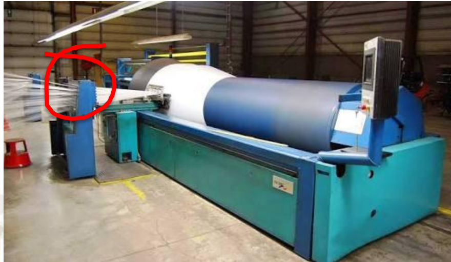
Imagen 3-4: Urdidora conformada por el Peine de Urdidora(con circulo rojo) y el Rollo de Urdimbre
