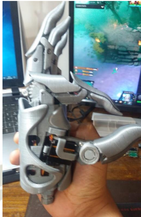
Figura 3.71: Vista lateral del ensamble de la mano robótica
