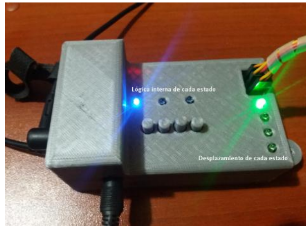
Figura 4.12: Acondicionado de los valores analógicos a digital de la co-contracción
