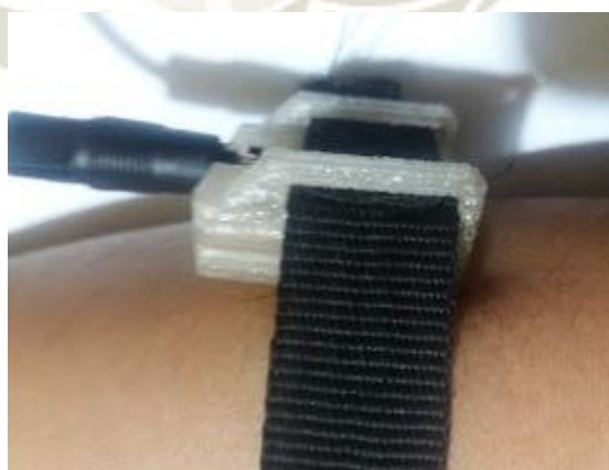
Figura 3.79: Ensamble de encapsulado IR
