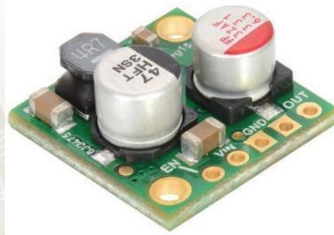
Figura 3.62: Regulador de voltaje Pololu 5V, 2.5A D24V25F5
