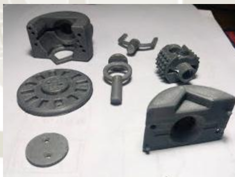
Figura 3.74: Piezas preensamble de soporte de la mano robótica
