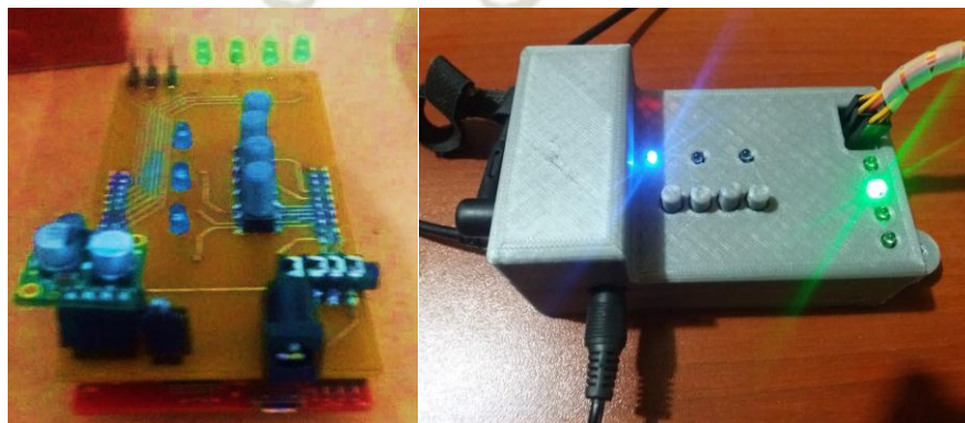
Figura 3.77: Módulo electrónico ensamble e impresión 3D
