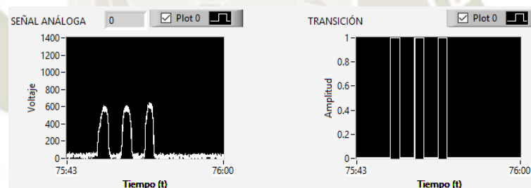
Figura 4.9: Acondicionado de los valores analógicos a digital del triple impulso (TI)
