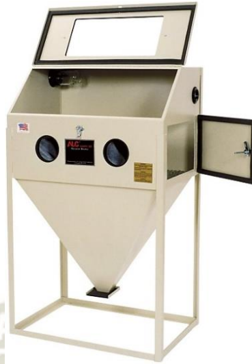
Figura 27. Gabinete de chorreado abrasivo. Fuente. (Northern Tool + Equipment, 2019)
