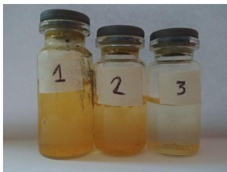
Figura 28 : Muestras procedentes del sistema PFTR empleando aguas sintéticas: Entrada (1), Salida de prueba sólo agar (2), salida de prueba agar + cepa (3)
