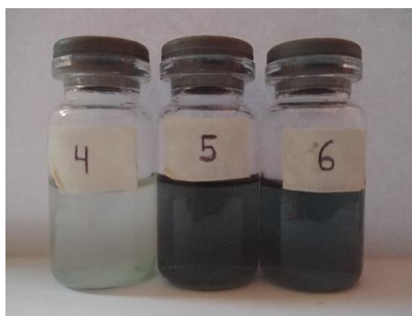
Figura 29 : Muestras procedentes del sistema PFTR empleando efluentes curtiembres: salida de prueba agar + cepa (4), Salida de prueba sólo agar (5), entrada (6).
