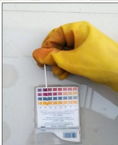
Figura 26. Comparando el papel indicador con la escala
