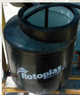
Figura 32. Tanque de 200litros adaptado para el tratamiento de los efluentes de la empresa INCAPIELES.
