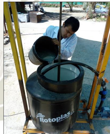
Figura 35. Verificando el ingreso de aire en el tanque.
