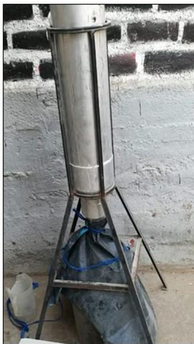
Figura 24. Filtrando los efluentes líquidos
