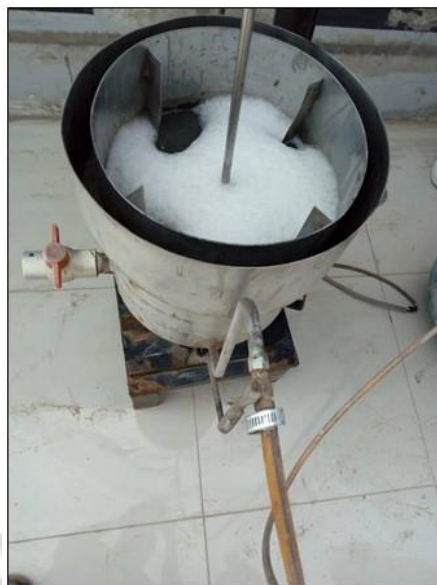
Figura 28. Agitación de los efluentes e inyección de aire para la oxidación de los sulfuros
