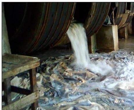
Figura 20. Efluentes líquidos con contenido de sulfuros luego del proceso de pelambre de las pieles
