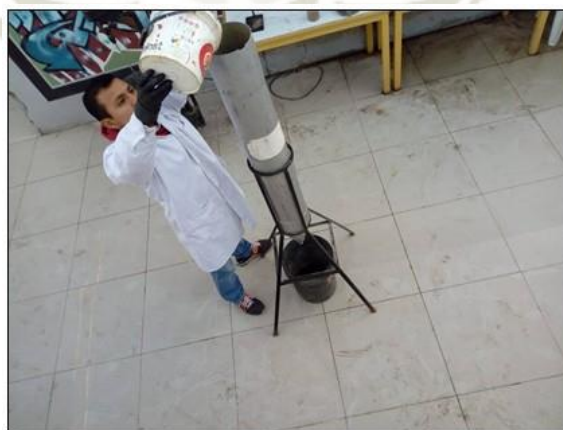
Figura 23. Pasando los efluentes por el filtro de arena
