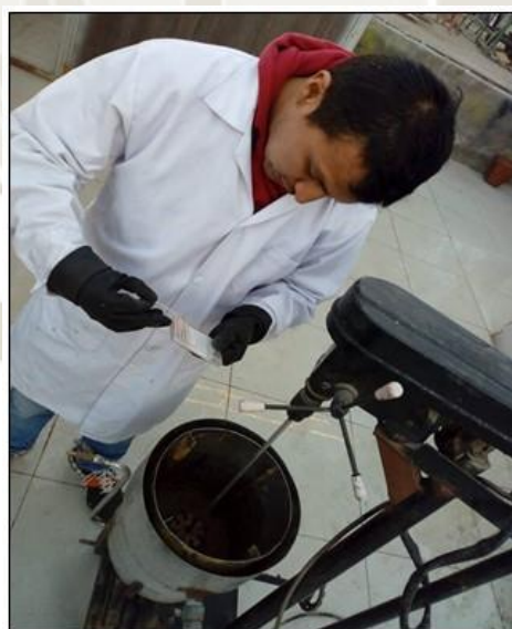
Figura 29. Control de pH luego de la agitación
