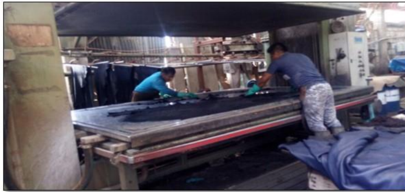
Figura 14. Estirado y Secado de piel en equipo Plancha
