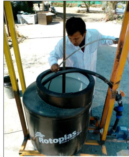
Figura 33. Llenando el tanque con efluentes luego del proceso de pelambre.
