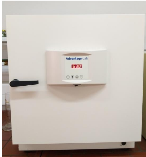
Slika 17 Sušionik (Binder) zagrijan na 63 °C (Izvor: autor)
