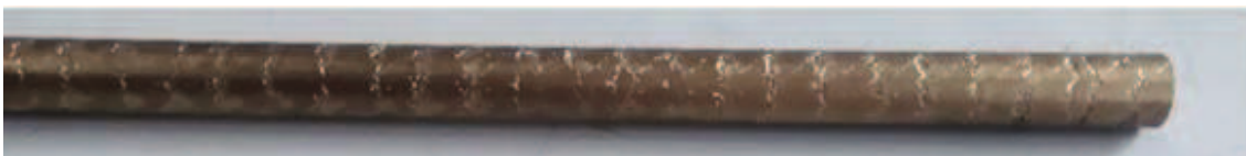
Slika 21. Fotografija cilindrične šipke Cu-Al-Mn legure s prisjetljivosti oblika promjera 8 mm
