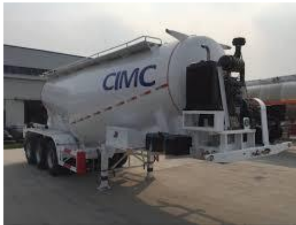
Slika 7. Cisterna za prijevoz cementa [17]
