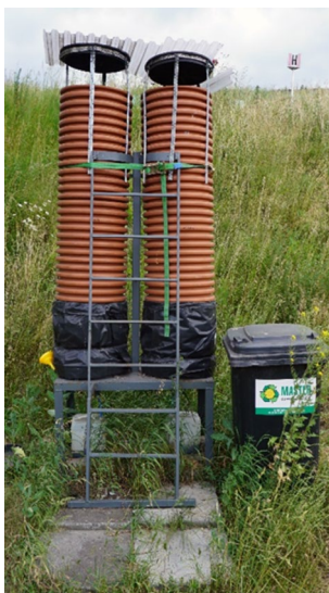
Fig. 2 Lysimeter research stand
