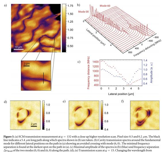
$\lambda = 780.1400 \text{ nm}$  (d) to  $\lambda = 780.2328 \text{ nm}$  (e) increases the size of the contour. (f) Scans (d) and (e) added up for comparison.
