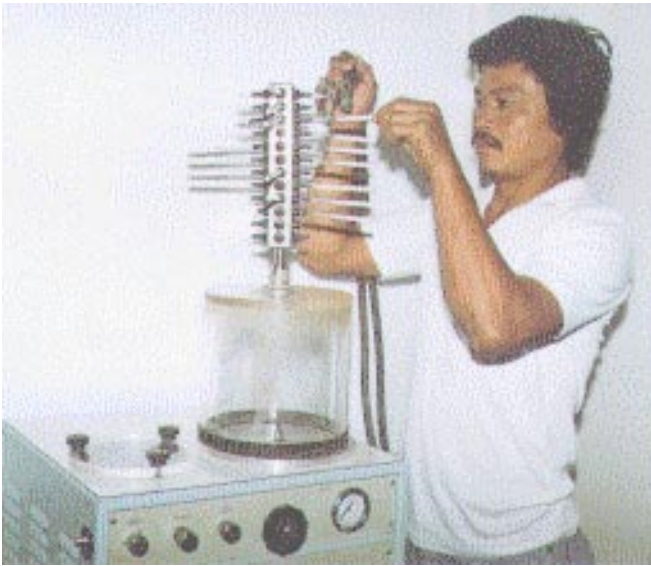
Fig. 27. Sellado de las ampolletas con un soplete
