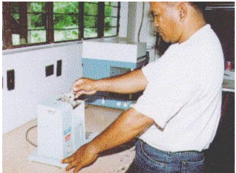
Fig. 25. Constrictor de ampollitas
