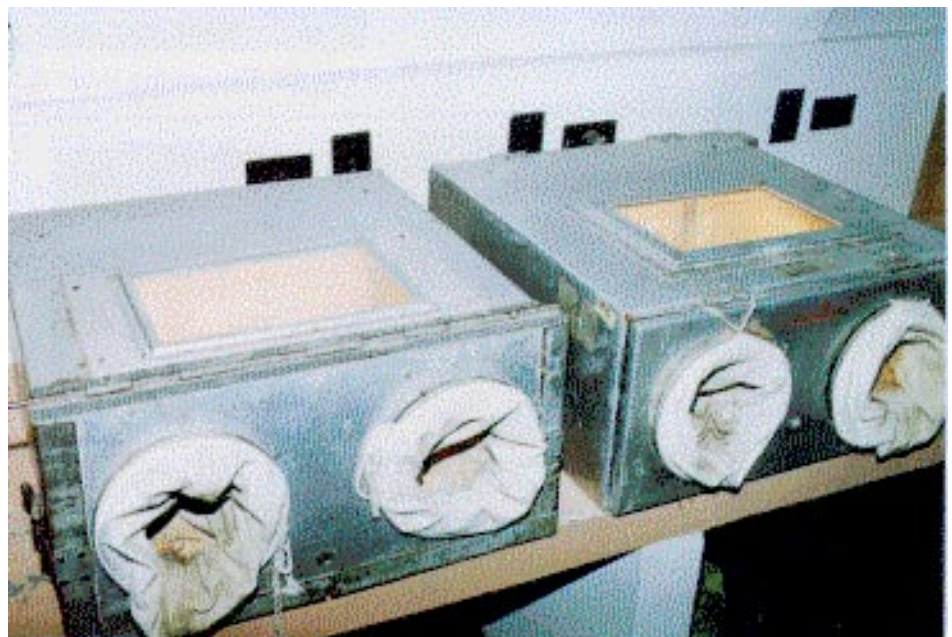
Fig. 18 . Esterilización de la Caja para Manipular Polen (CMP) usando dos focos de infrarrojo (1000 watt por foco)
