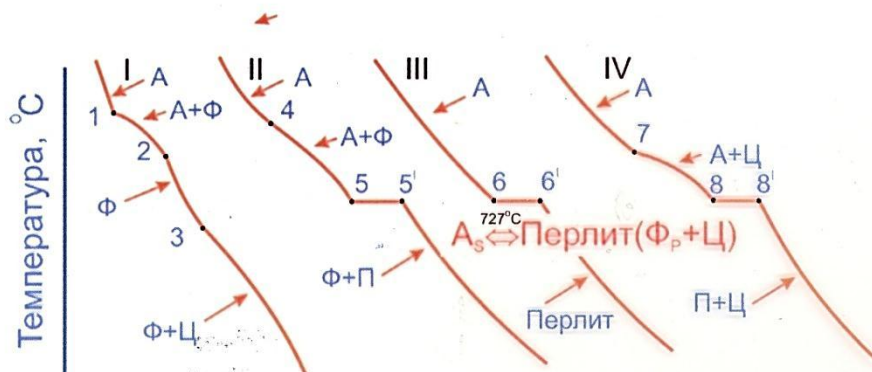
Рис. 32. Термические кривые охлаждения, на основании которых построена диаграмма железо-углерод, позволяют рассмотреть изменения фазового состава в процессе кристаллизации (линии ликвидус) и перекристаллизации в твердом состоянии при эвтектоидной температуре (линия PSK)
