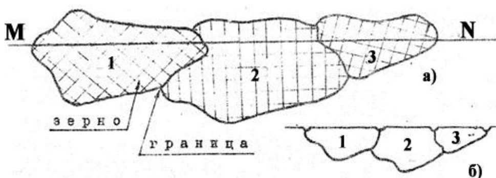
Рис. 18. Схематическое увеличенное изображение поверхности: а – неполированного образца б – микрошлифа после травления; MN – плоскость шлифа, выше которой был снят слой металла полировкой
