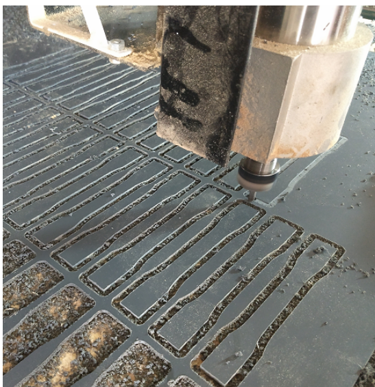
Figura 23 – Processo de corte pela Router CNC em execução
