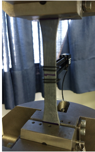
Figura 33 – Corpo de Prova instalado para ensaio de tração e extensômetro na posição horizontal
