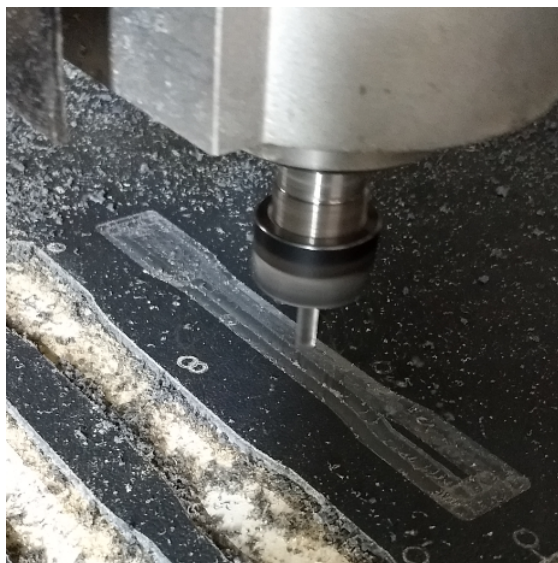
Figura 24 – Router CNC realizando desbaste da camada superior da chapa ABS
