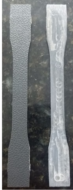
Figura 26 – Comparação entre corpos de prova sem desbaste e com desbaste logo após o corte
