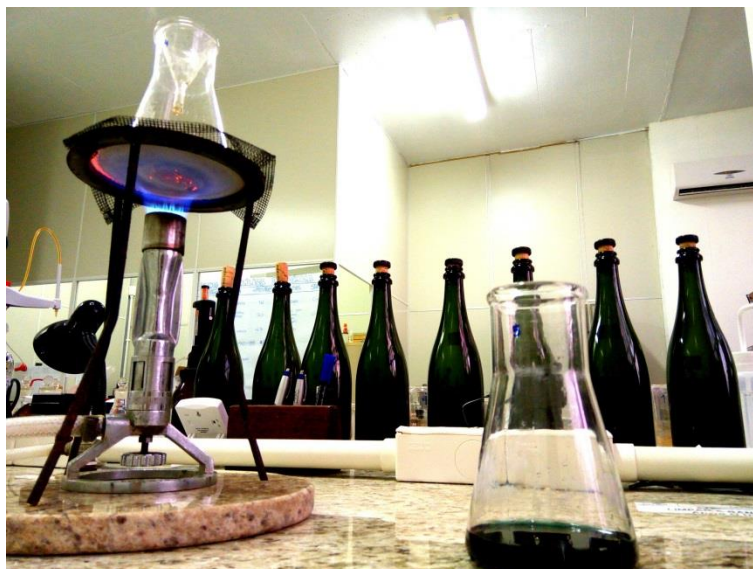
Figura 17. Processo para a determinação dos açúcares redutores. Foto da autora. Embrapa CNPUV.
