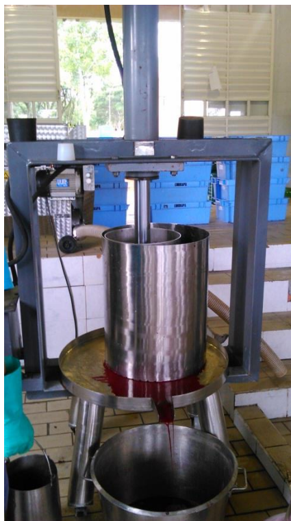
Figura 8. Prensagem da fase sólida das uvas destinadas à elaboração de vinhos base para espumantes tintos. Foto da autora. Embrapa CNPUV. Bento Gonçalves, 2015
