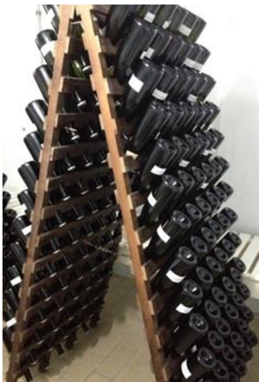
Figura 11. Espumantes dispostos no pupitre para serem submetidos à rémuage . Foto da autora. Embrapa CNPUV. Bento Gonçalves, 2015
