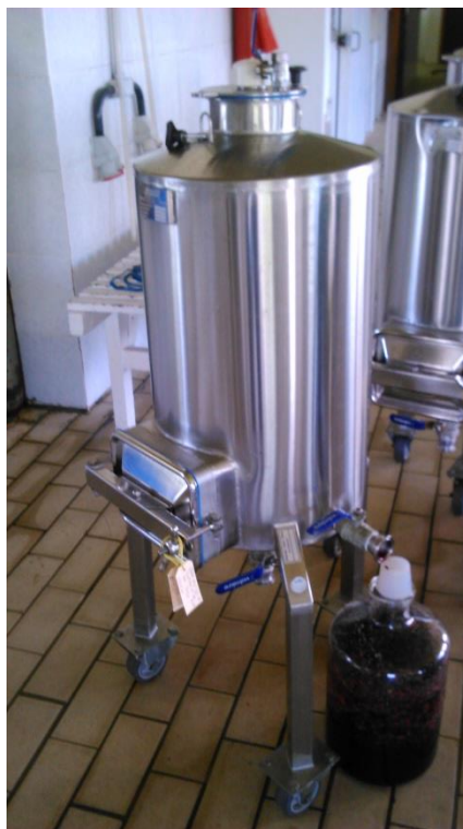
Figura 7. Tanque inoxidável para fermentação e estocagem de vinhos.
