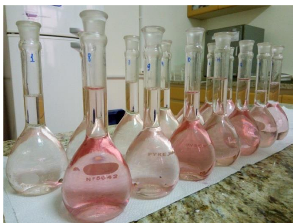
Figura 18. Amostras dos espumantes preparadas para a medição do IPT. Foto da autora. Embrapa CNPUV. Bento Gonçalves, 2015
