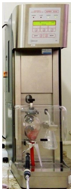
Figura 15. Destilador Enológico Digital – Modelo SUPER DEE Gibertini. Modelo usado para medições de acidez volátil, teor alcoólico e compostos voláteis. Foto da autora. Embrapa CNPUV. Bento Gonçalves, 2015
