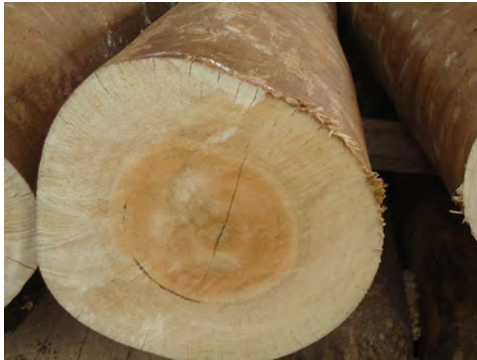
Figura 1. Madeira de eucalipto mais desejável para tratamento devido ao cerne de menor diâmetro e albúrnio mais espesso.
