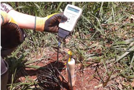
**Figura 7.** Leitura de umidade do solo com medidor HH2 portátil conectado à sonda de perfil na área experimental.
