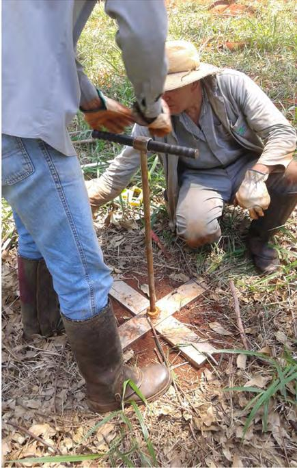
**Figura 4.** Instalação do tubo de acesso para sonda de perfil FDR em dezembro de 2015 na área experimental.
