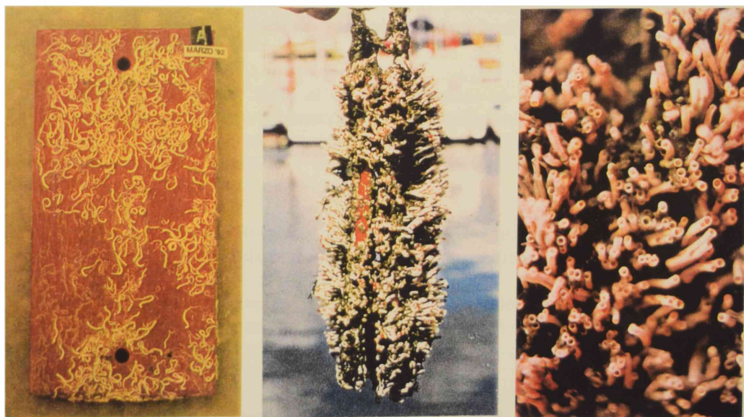
Fig. 11.- Tubos de serpúlidos adheridos a paneles de ensayo, a) vista frontal; b) vista lateral; c) Detalle (10 x).
