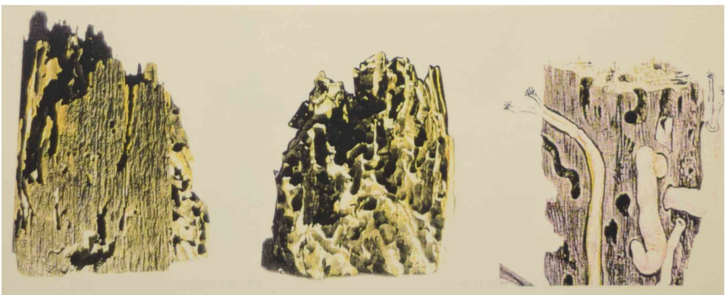
Fig. 14.- a) Aspecto externo de un pilote de madera perforado por Teredo ; b) aspecto interno del mismo pilote; c) esquema del molusco dentro de su habitáculo.
