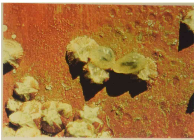
Fig. 15.- Aspecto de la fijación de cirripedios sobre una placa pintada: la coloración de las paredes de los caparazones evidencia el crecimiento de los organismos por debajo de la película de pintura. Se observan ascidias fijadas sobre cirripedios (epibiosis).
