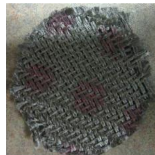
Outer Layer (Metal Fiber)
