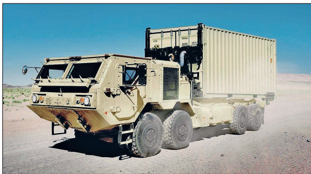
7. ábra. A jól bevált Oshkosh HEMTT már villamos hajtással is elérhető (TruckTrend)
