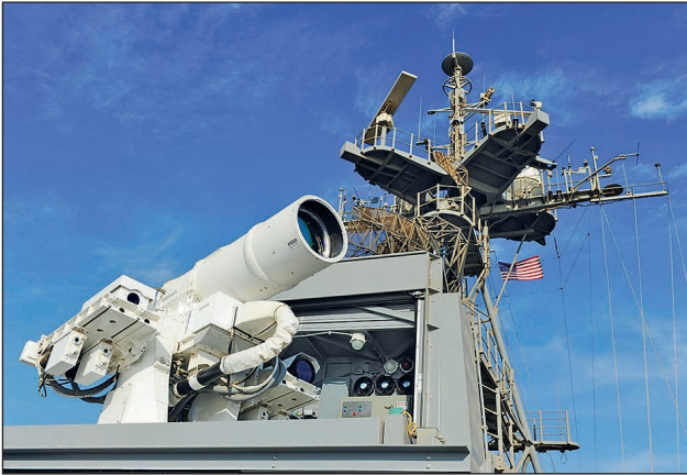
4. ábra. A San Antonio osztályba tartozó USS PORTLAND-ot már biztosan felszerelik a képen látható vízfelszíni rakéták ellen kifejlesztett lézerrel [10]
