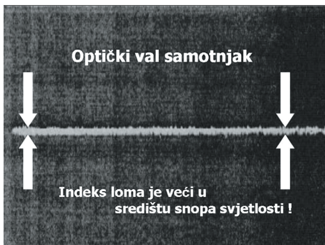
Slika 5. Optički val samotnjak. Laserski snop svjetlosti ulazi s lijeve strane u nelinearan medij. Intenzitet svjetlosti je najveći u središtu snopa. Zbog nelinearnosti, indeks loma je također veći u središtu (vrlo malo veći, ali dovoljno za stvaranje efekta).
