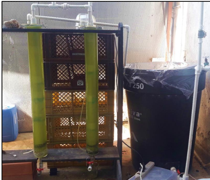
Figura 6. Montaje del sistema de tratamiento con la microalga Chlorella sp. en un reactor tipo Batch. Adaptado de “Eliminación de fosfatos y nitratos de agua residual municipal mediante un inóculo optimizado de Chlorella sp. en un sistema de fotobiorreactores verticales con columna de burbujeo a escala piloto”.
