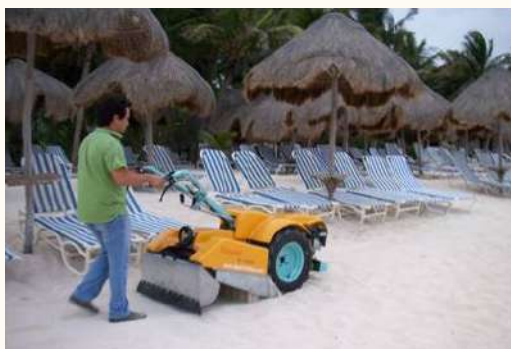
Figura 1. Limpiando un área de un hotel con una máquina tamizadora autopropulsada.
