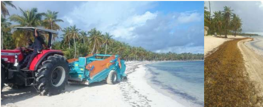
Figura 3. Las máquinas tipo Scarbat levantan el sargazo de la orilla y mantienen la morfología de la playa, retirando solo el sargazo y devolviendo la arena a la playa. Obsérvese como después de pasar la máquina, la playa mantiene su nivel.
