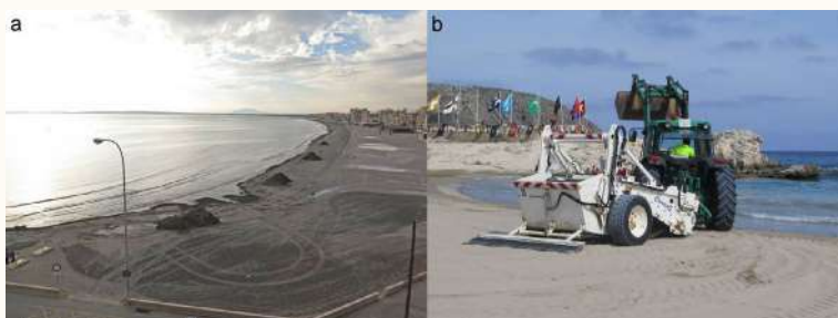
Figura 5. a) Resultado de una limpieza mecánica donde se han eliminado la mayoría de los residuos sólidos y se han acumulado los restos vegetales de Posidonia oceanica y Caulerpa prolifera para su posterior retirada (Santa Pola, España). b) Tractor con máquina de rastrillo y cribado en plena limpieza de playa (España).
