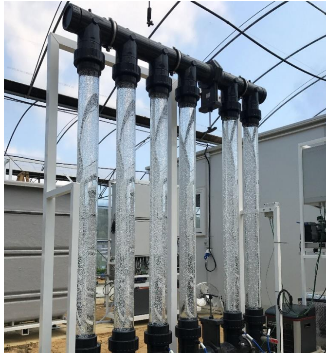
Figura 3. Fotobiorreactor tubular en formato columna de burbujas. Adaptado de “5 – 600L Airlift Photobioreactor”, por Varicon Aqua, 2016.
