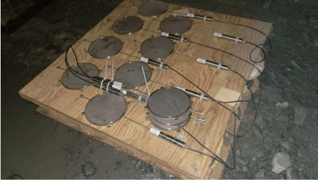
Figure 3-11 Cellules de pression (TPC) (sous terre à la mine Westwood)
