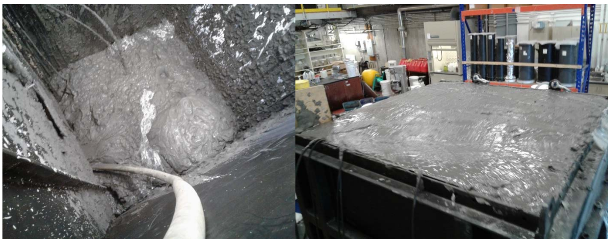
Figure 3–26 Remblayage du modèle physique de chantiers avec du remblai en pâte cimenté : début de la coulée (gauche) et fin de la coulée (droite)
