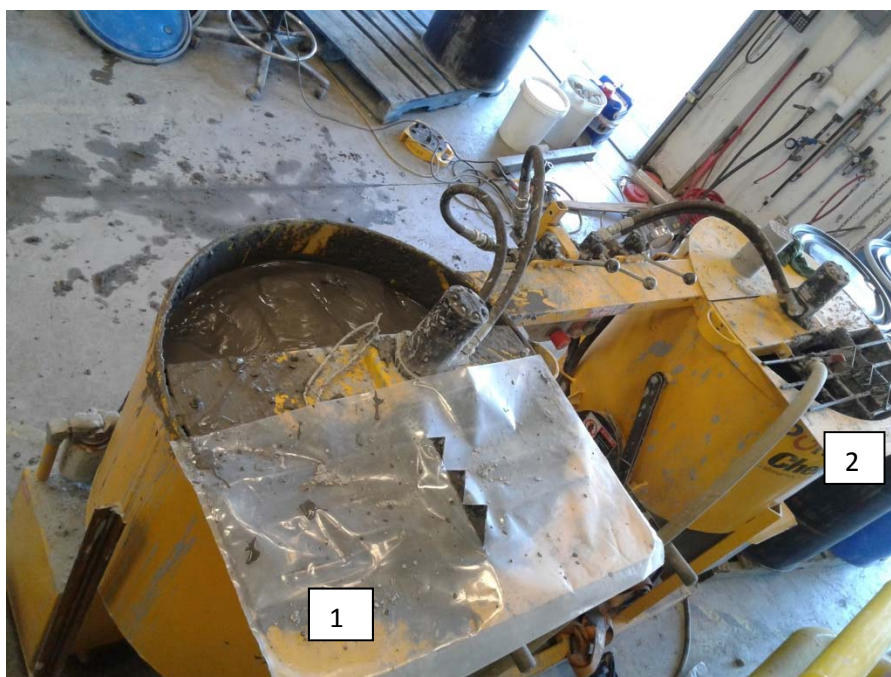
Figure 3–25 Préparation du remblai dans le mélangeur-pompe
