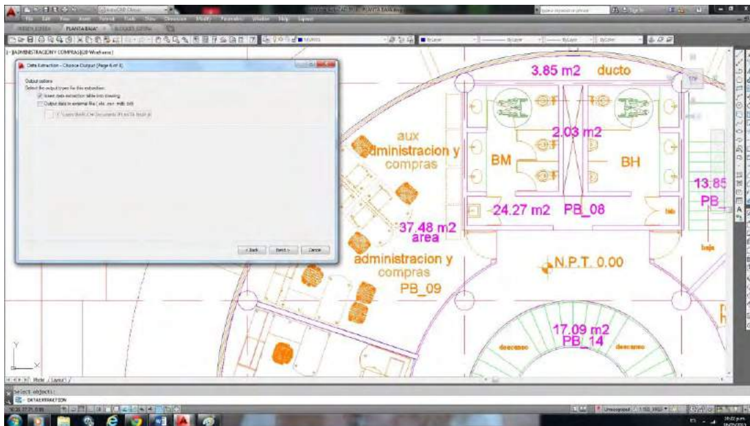
Fig. 200 Pantalla de resultados para la extracción de datos, paso 6, fuente Baruch Martínez.
