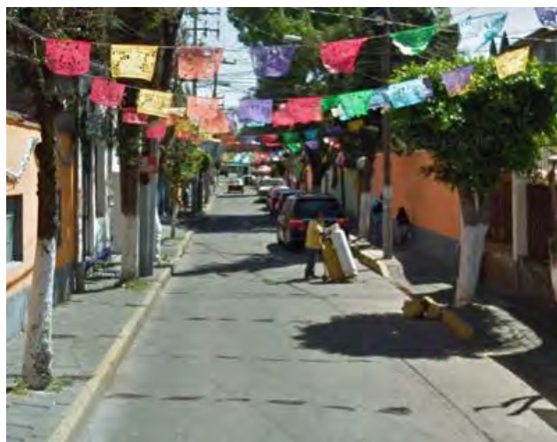
Imagen 165. Fotografía de la calle Vicente Guerrero entre Matamoros y Pedro Ramírez del Castillo, en la cual se observa la ubicación de árboles y postes en el centro de la banqueta, lo que provoca que la gente que utiliza silla de ruedas o carriolas, no puedan transitar por la misma, centro Histórico de Xochimilco, octubre 2015.
