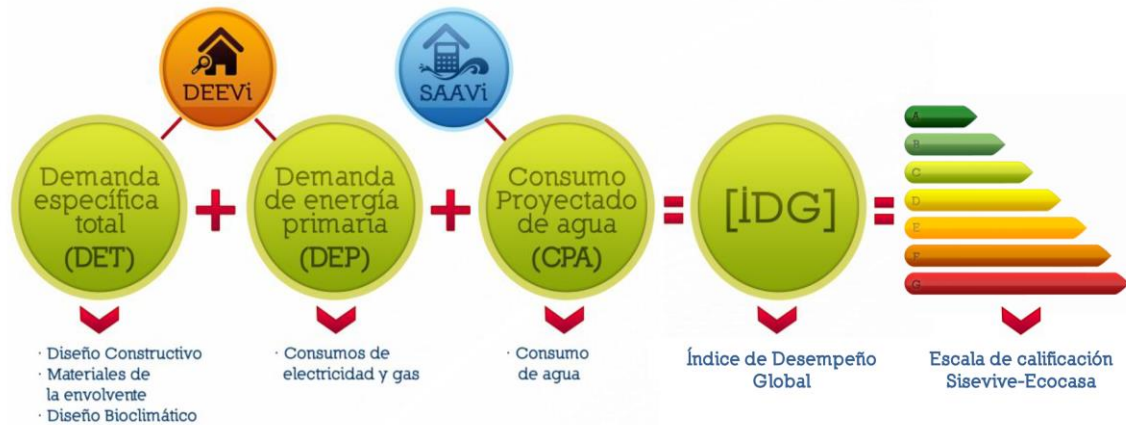
Figura 18. Esquema de operación del Sistema de Evaluación de la Vivienda Verde (INFONAVIT, 2014c).
