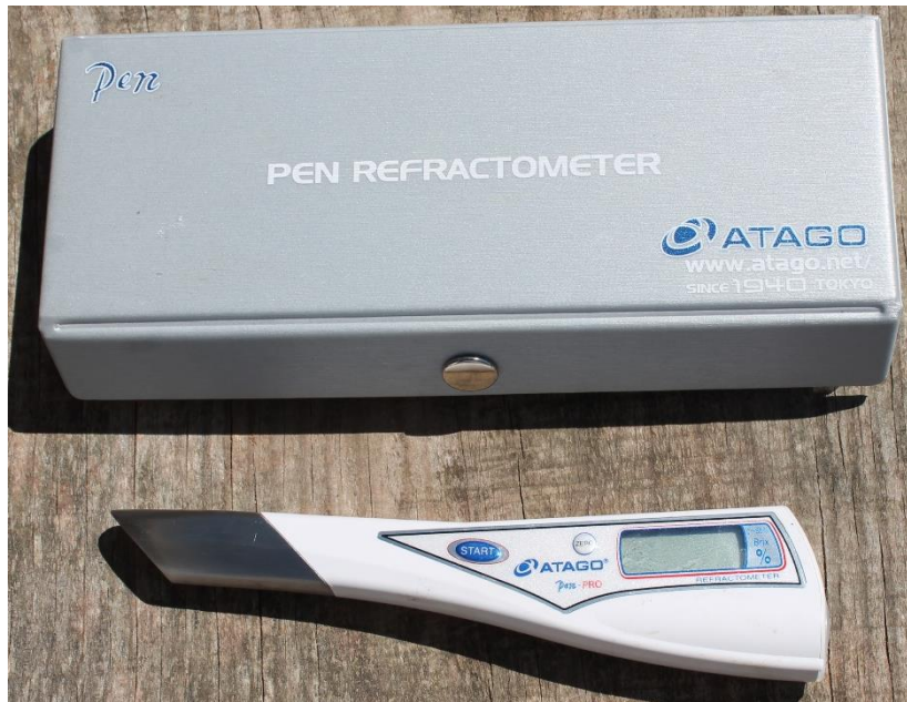
Figura 8 - Refratômetro portátil utilizado para medir o grau brix (%).
