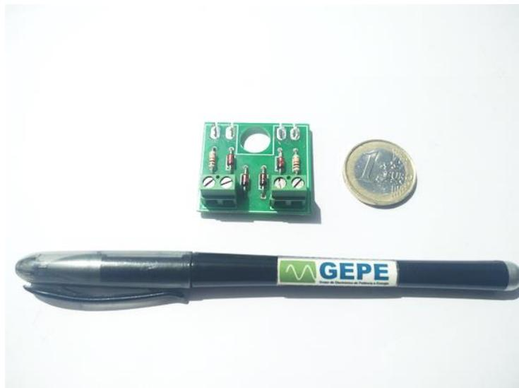
Figura 5.6. Placa de proteção de *gate* dos IGBTs.
