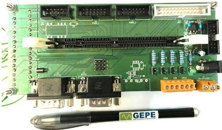
Figura 5.21. Adaptador do DSP (*docking station*).
