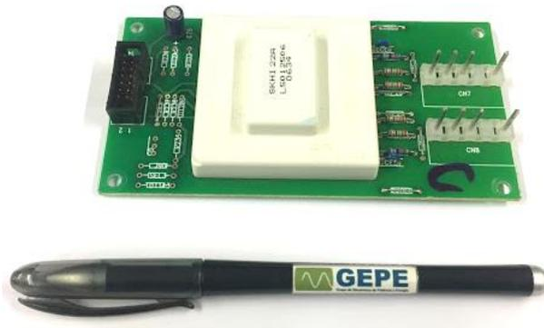
Figura 5.9. Placa de *driver* modelo *SKHI22A(R)*, *Semikron*.
