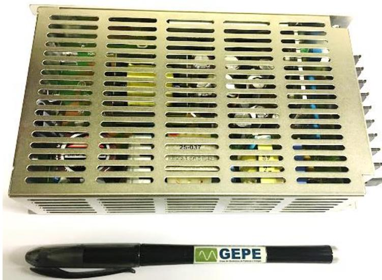
Figura 5.23. Fonte de Alimentação modelo TXL 060-0533TI, *Traco Power*.
