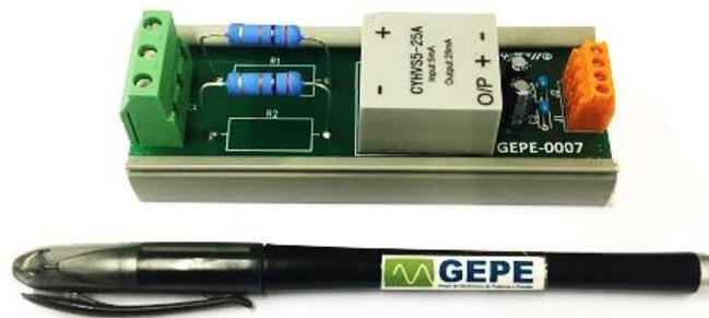
Figura 5.14. Sensor de tensão CYHVS5-25A, *ChenYang Sensors*.
