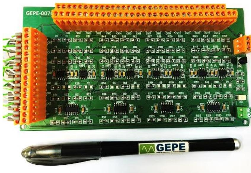
Figura 5.17. Placa de condicionamento de sinais e deteção de erros (*top*).
