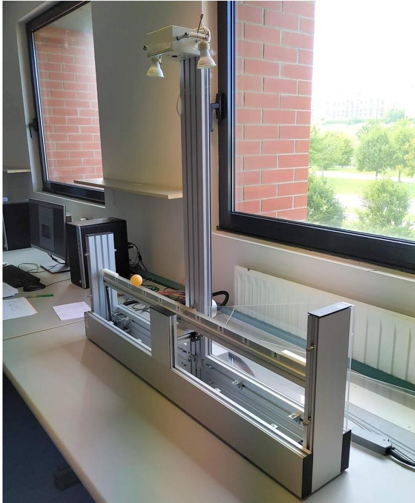
*Figure 2: Planta Bola-Viga real.*
