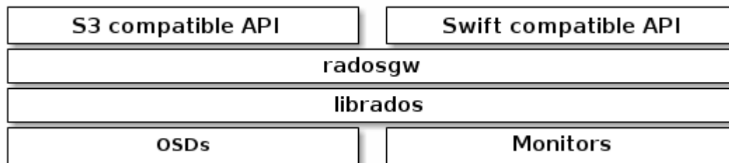
Figura 11: Interfaces y componentes de Ceph. Fuente: [46]
