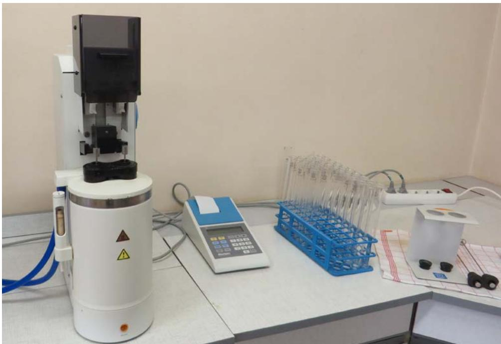
Abbildung 2: Fallzahlgerät Falling Number 1900 der Firma Perten Instruments mit Viskometerröhrchen und Viskometer (Foto: Herzog, 2016)
