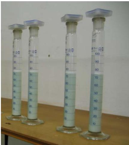
Abbildung 3: Das Volumen des Sedimentes in ml ist der Sedimentationswert (Foto: Herzog, 2011)
