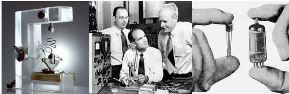
**Figura 1.2** (a) Primer transistor creado en los Laboratorios Bell. (b) Fotografía de Shockley, Bardeen y Brattain trabajando en los laboratorios. (c) Comparativa entre los tamaños de un transistor (izquierda) y un tubo de vacío (derecha).
