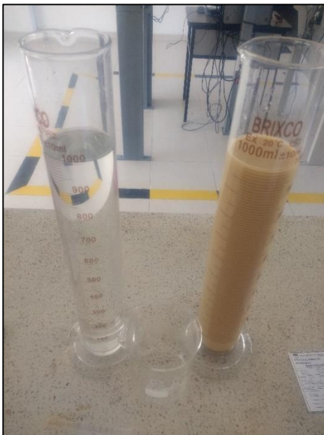
Figura 13. Probetas con agua y suelo en dispersión
