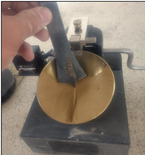
Figura 7. Separación de muestra con ranurador
