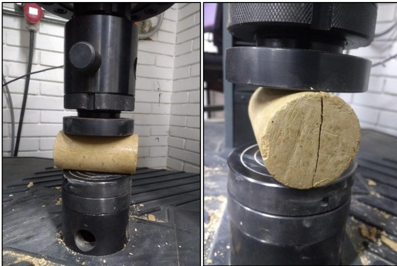
Figura 20. Falla de cilindros a tracción indirecta
