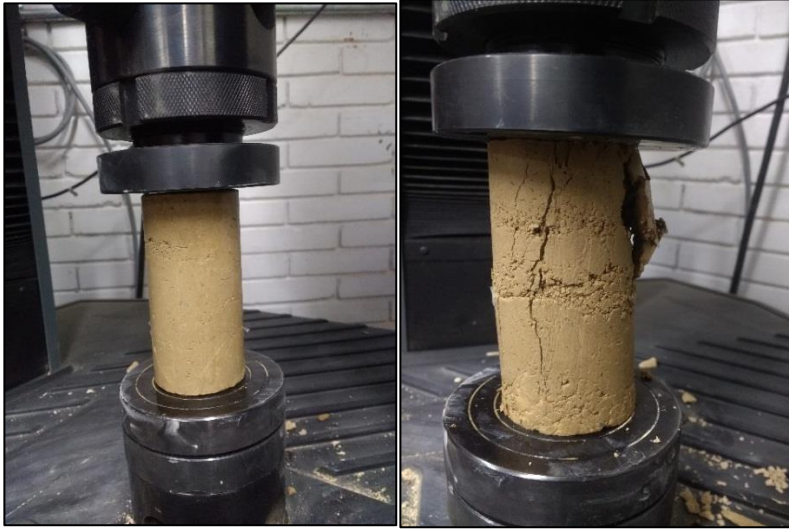
Figura 19. Falla de cilindros a compresión inconfiada
