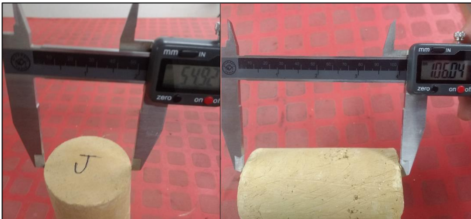
Figura 18. Toma de diámetro y altura a cilindros
