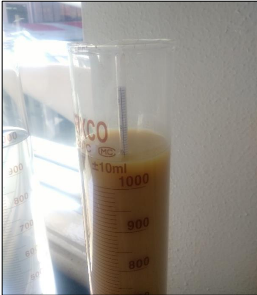
Figura 14. Medición de profundidad con el hidrómetro
