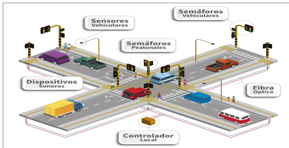
Ilustración 14 Componentes control del tráfico en la ciudad de pasto
