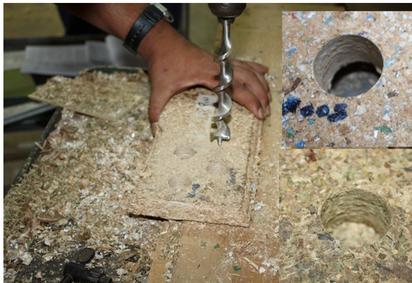
Figura 5. Operación de taladrado en tableros aglomerados de residuos agroforestales. Se muestra la calidad del orificio en un tablero con componente tetrabrik y el otro con componente de piña.
