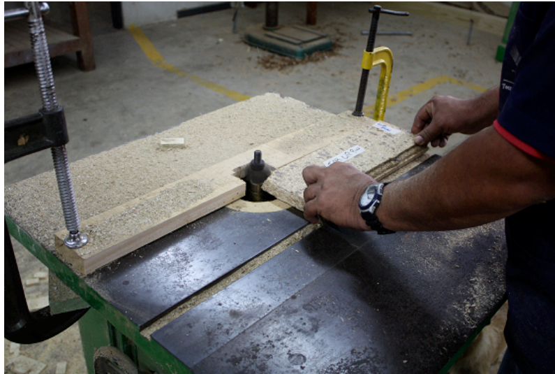
Figura 4. Operación de moldurado en tablero hecho de madera de melina y las hojas de piña.
