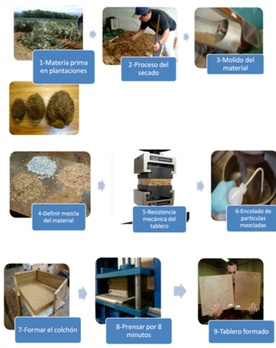
Figura 2. Esquema de fabricación del tablero de entre aserrín de las principales especies de reforestación en Costa Rica y 3 tipos de residuos proveniente de desechos agrícolas y cajas TetraBrik® para la comercialización de leche y refrescos
