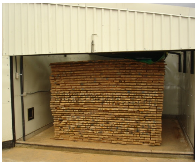
Figura 3. Secadora solar con capacidad máxima de 6 m 3 instalada en el Instituto Tecnológico de Costa Rica en Cartago.
