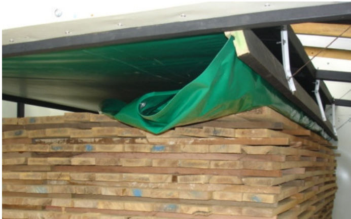
DETALLE DE INSTALACION Y UBICACIÓN DEL BAFLE
