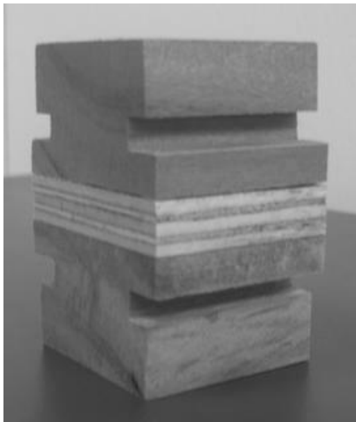
Figura 5. Probeta para el ensayo de tensión perpendicular unida a las placas de madera.
