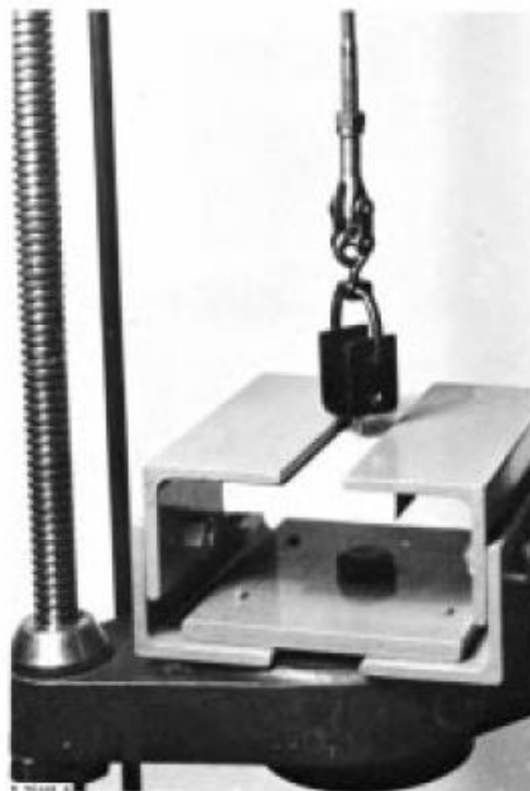
Figura 10. Ensamble del ensayo para medir la resistencia de clavos a retiro directo.
