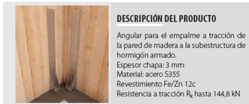
**Figura 3.46 Angular para empalme a tracción WHT**
