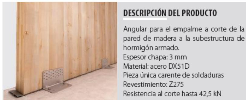
**Figura 3.41 Angular cortante Muro-Cimentación**
