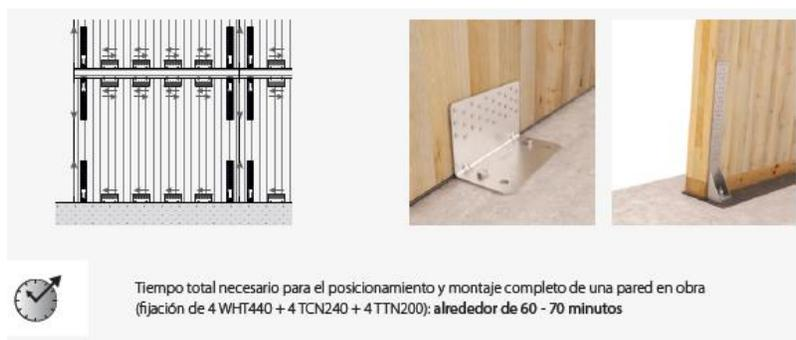
**Figura 3.10. Sistema de conexiones de CLT tradicional**
