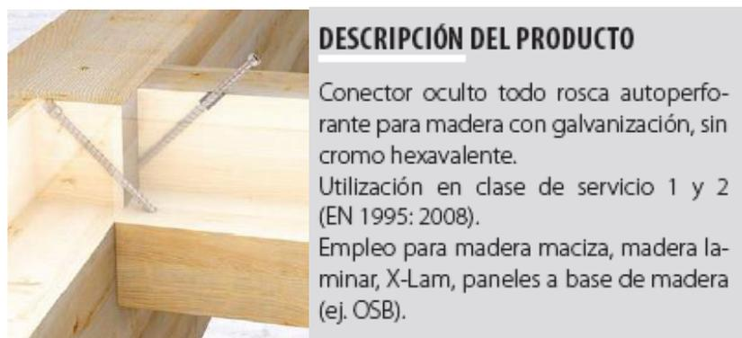
Figura 3.60 Unión Viga-Muro VGZ
